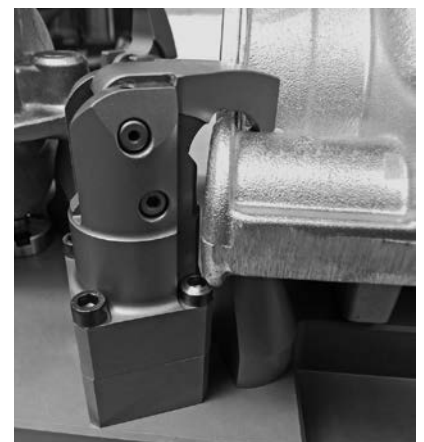
Spannen eines Gussteils mit Sonder-spannhebel
