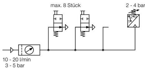
Zur Auswertung des pneumatischen Druckaufbaus können handelsübliche Pneumatik-Druckschalter verwendet werden. Es ist möglich mit einem Druckschalter bis zu 8 parallel geschaltete Positionskontrollen abzufragen (siehe Schaltplan).
